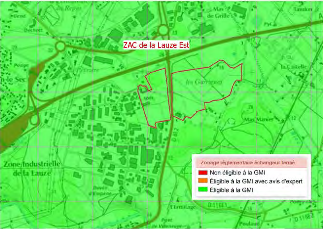
Figure 17 : Zonage réglementaire pour la géothermie sur capteurs verticaux (BRGM)
